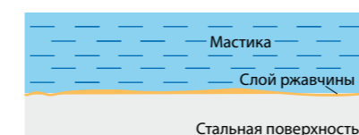
Мастика проникает сквозь ржавчину до стальной подложки.
